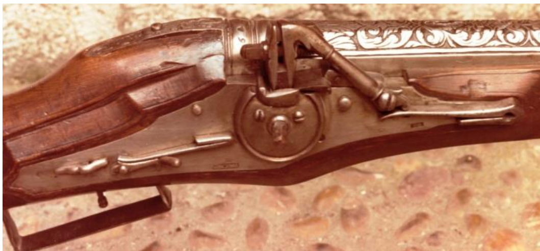
Llave de rueda, armería del Palacio Real de Madrid (foto del autor)
